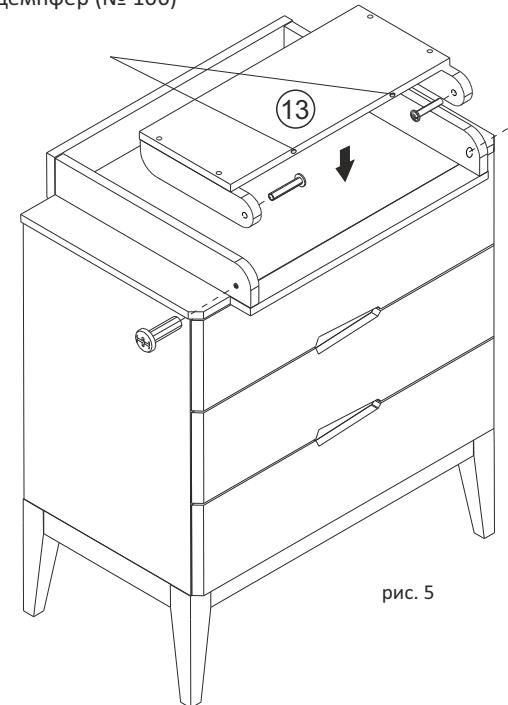
Соедините собранные детали столика, как показано на рисунке 5, с помощью стяжки межсекционной (№ 105).
