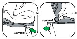
3- Расположение основания на автомобильном кресле. Защелкните крепления FIX в точках крепления ISOfix на автомобильном кресле. Убедитесь, что ОБА индикатора крепления FIX -ЗЕЛЕНОГО ЦВЕТА (4).
