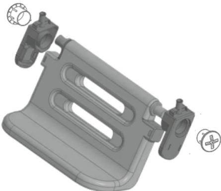
Установите крепления подножки А и В с помощью винтов А
