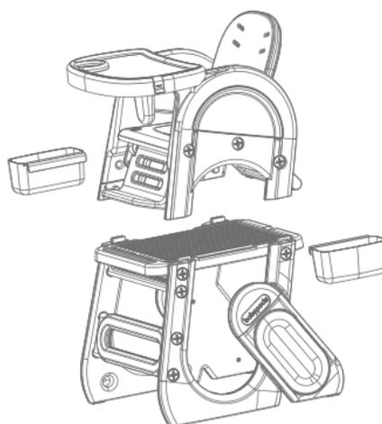
Установите сиденье со столиком на столешницу и нажмите фиксирующие кнопки по углам, чтобы закрепить конструкцию. Наконец, закрепите коробка для хранения по бокам столешницы. На этом сборка завершена
