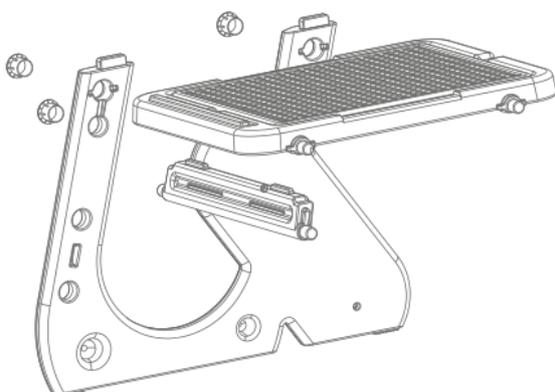
Закрепите скобу С выпирающим концом под столешницей на левой нижней панели с помощью винтов А
