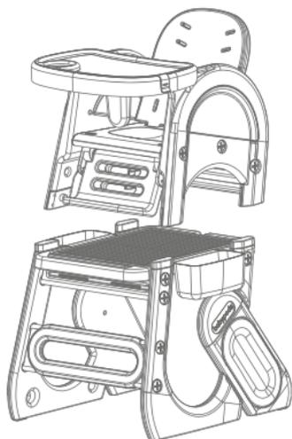
Нажмите фиксирующие кнопки по четырем углам столешницы, чтобы снять кресло со стола
