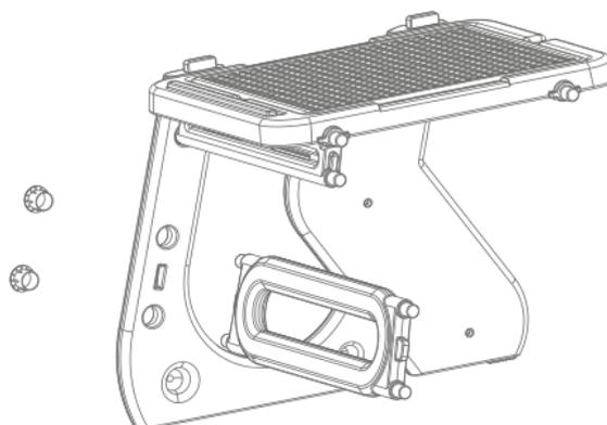
Закрепите скобу В на левой нижней панели с помощью винтов А
