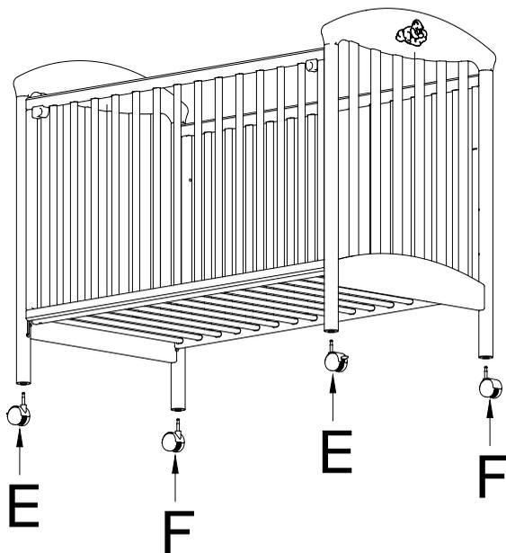
В спинки кровати 1 и 2 вставьте колеса E и F. После того, как Вы сделали всё указанное выше, затяните до конца все болты и гайки ключом G.
