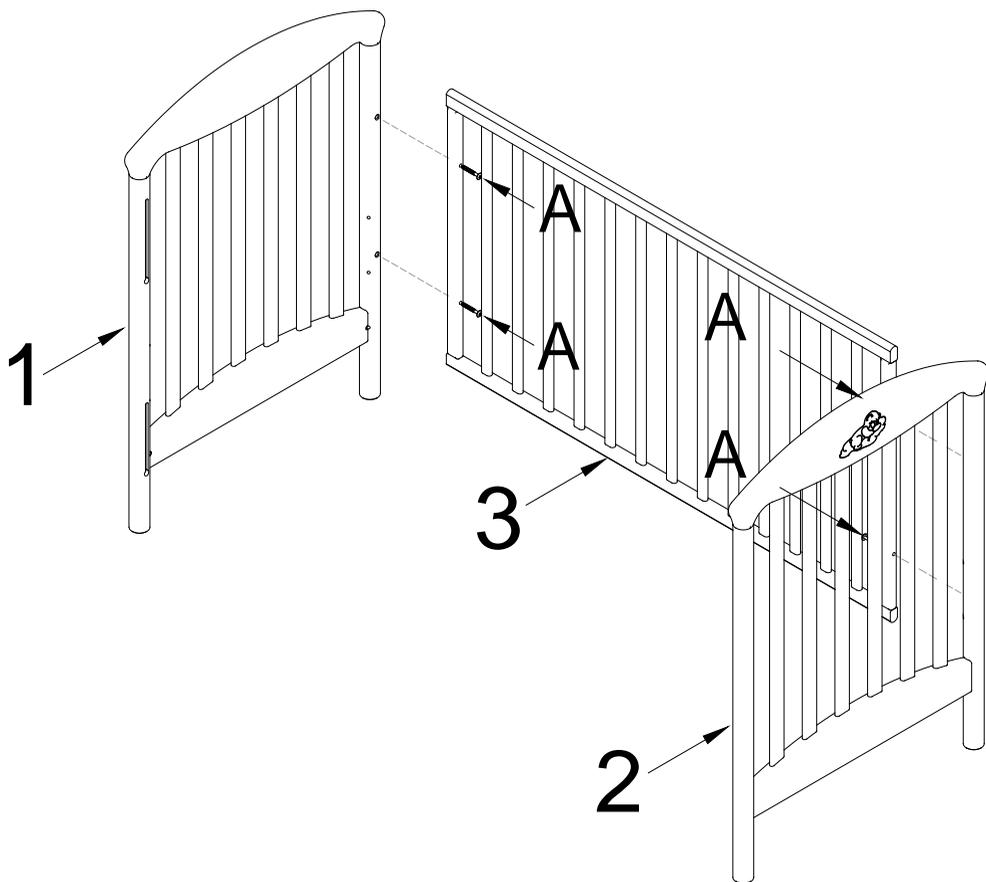
Спинки кровати 1 и 2 и неподвижную боковину 3 зафиксируйте с помощью винтов А. Для этого используйте ключ В.
