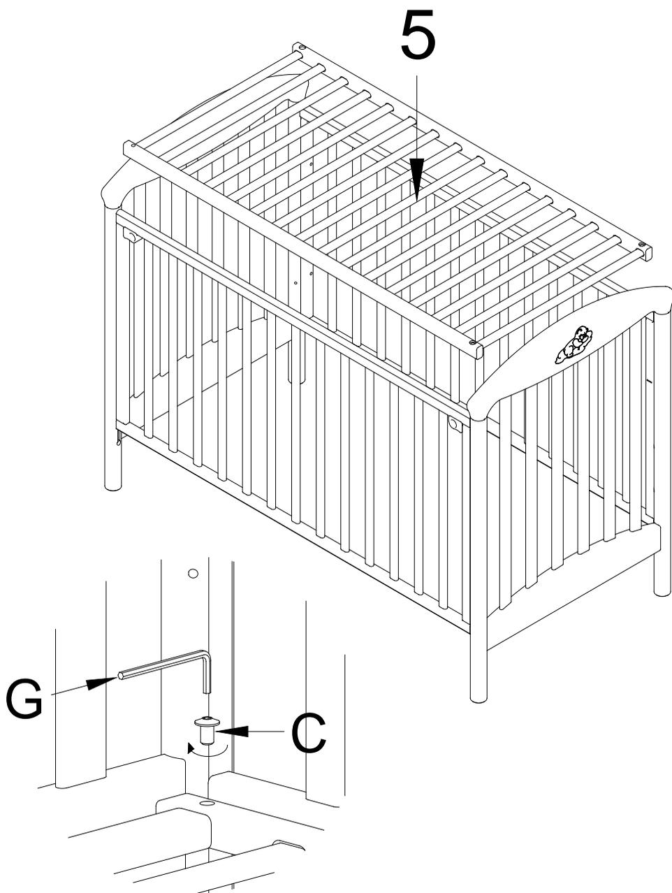
Зафиксируйте ложе 5 с помощью винтов С.
