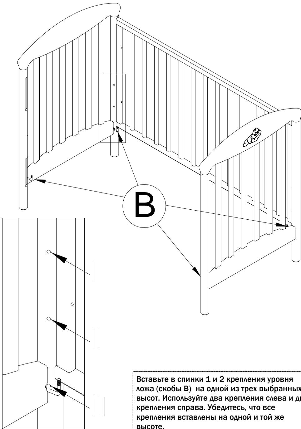
Вставьте в спинки 1 и 2 крепления уровня ложа (скобы В) на одной из трех выбранных высот. Используйте два крепления слева и два крепления справа. Убедитесь, что все крепления вставлены на одной и той же высоте.
