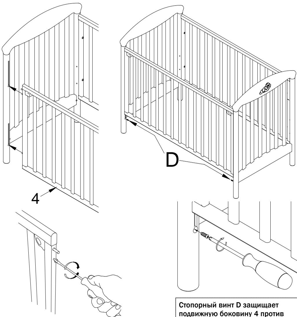
Стопорный винт D защищает подвижную боковину 4 против выпадения.
