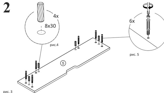
2. В фасады (дет. 5) согласно отверстиям установить шкант 8x30 (№ 3) (рис. 4) и ввинтить дюбель стяжки эксцентриковой (№ 2) (рис. 5).
