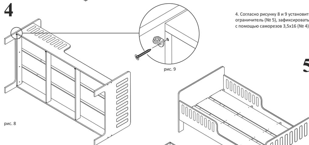
4. Согласно рисунку 8 и 9 установить ограничитель (№ 5), зафиксировать с помощью саморезов 3,5x16 (№ 4).
