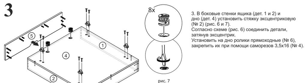
3. В боковые стенки ящика (дет. 1 и 2) и дно (дет. 4) установить стяжку эксцентриковую (№ 2) (рис. 6 и 7). Согласно схеме (рис. 6) соединить детали, затянув эксцентрик. Установить на дно ролики прямоходные (№ 6), закрепить их при помощи саморезов 3,5x16 (№ 4).
