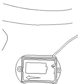
5. Сдвиньте крышку отсека для батареек влево.
