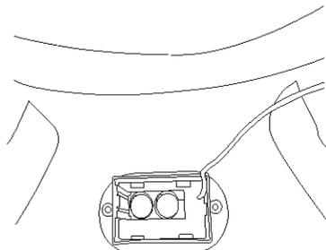
6. Поднимите крышку и установите батарейку на место. Закройте крышку.
